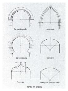
Los elementos fundamentales del arco son (ver la figura del Arco más abajo): dovelas, sillares radiales en forma de cuña; salmer, las dos primeras dovelas; clave, la central y más alta; impostas, donde se apoya el arco; luz, su anchura; intradós, parte interna o inferior; trasdós, parte externa o superior.
